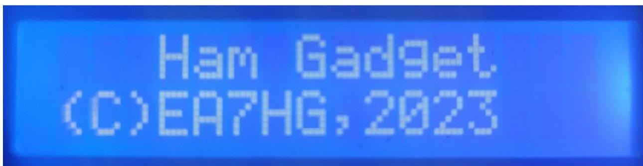
Una vez finalizada la presentación, la pantalla puede mostrar la siguiente información, en caso de que no este conectado el cable CI-V al transceptor, que la dirección hexadecimal no sea la correcta (A2, por defecto) o la velocidad en baudios sea distinta de 19200 baudios.
