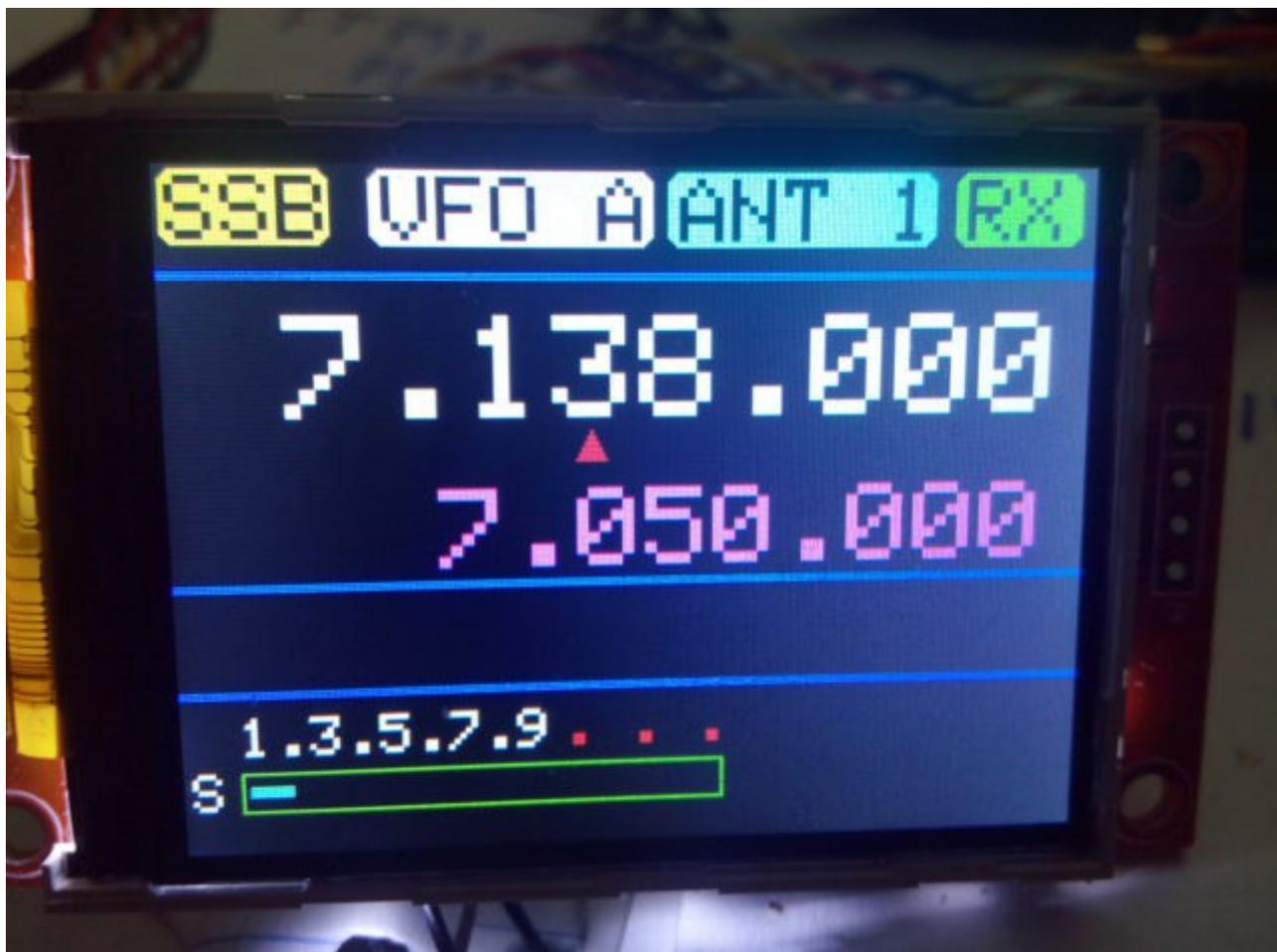
Super-Vfo es realmente un programa creado para Arduino Uno o Arduino Pro Mini 16Mhz, junto una pantalla de TFT QVGA de 320\*240 con ILI9340, un DDS con AD9850 o AD9851 y un encoder que permite hacer todas las funciones necesarias sin usar ningún pulsador adicional, solo el del encoder, usandolo como un VFO.
