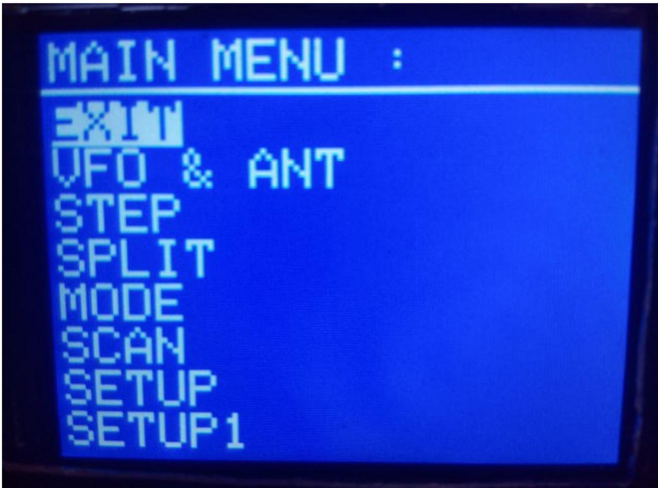
La primera función que le aparece es **EXIT** (SALIDA). Permite la salida del Menú y volver al funcionamiento normal. Si vuelve a pulsar hacia adentro el botón de sintonía saldrá del modo Menú. Si gira el botón de sintonía hacia la derecha o la izquierda se irá desplazando por las demás opciones del menú.
