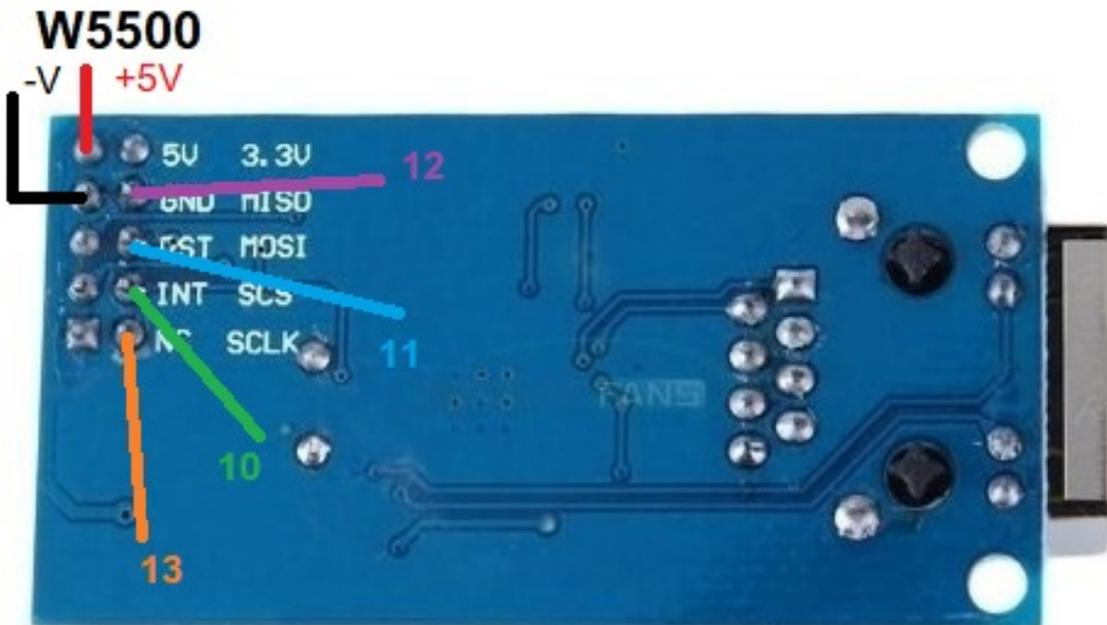
**Conexão Ham Rotor com W5100:**
