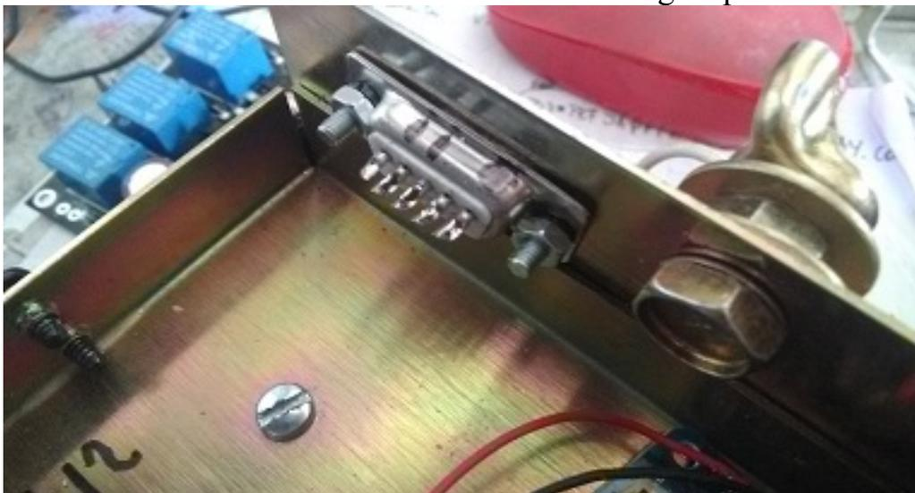
Löten Sie die Drähte, die von der mit 2,3,5 gekennzeichneten gedruckten Schaltung neben der integrierten Schaltung zu den Stiften des RS232-, 2-, 3- und 5-Steckverbinders führen.
