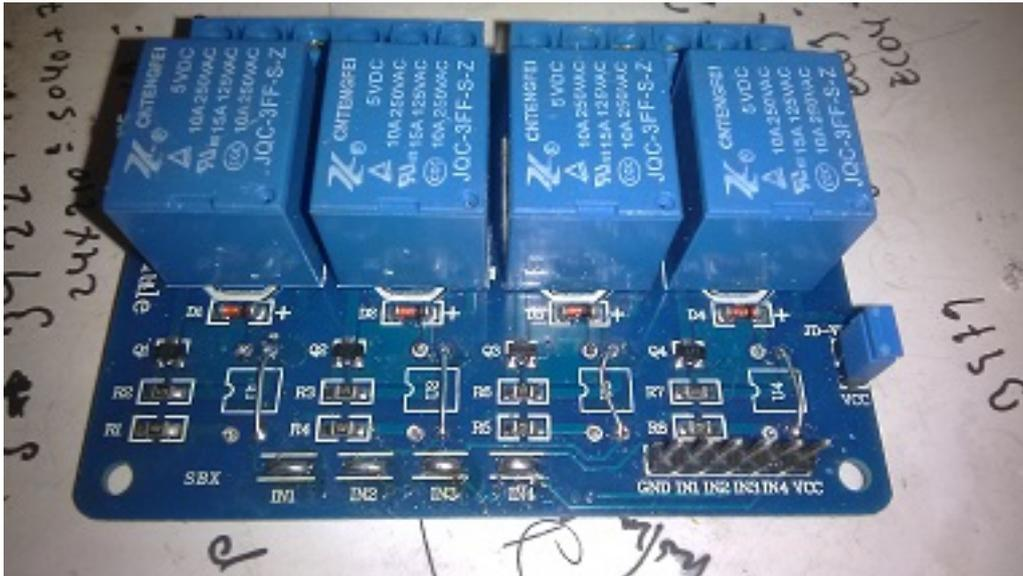
Wenn wir zum Beispiel einen Ham IV benutzen wollen, brauchen wir mindestens eine Platte, die drei Relais enthält, so dass eines für die linke Abzweigung, eines für die rechte Abzweigung und ein weiteres Relais zum Entfernen / Setzen der Bremse von diesem benötigt wird Rotor.
