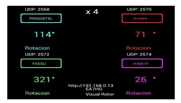
Le mode A-E permet d'afficher simultanément le rotor de rotation et le rotor d'élévation, avec un seul port série et UDP (2568) pour le suivi des satellites, de la lune, etc.
