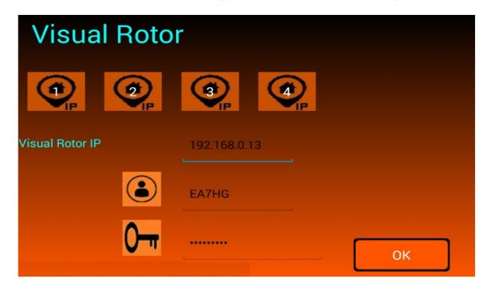
Lorsque la LED installée sur la broche A14 de l'Arduino Mega 2560, elle s'allumera indiquera qu'elle est prête à se connecter à l'application Android et permet également de gérer le rotor dans sa forme d'origine. Une fois que l'adresse IP ou le serveur DDNS a été entrée, elle sera enregistrée bien qu'elle puisse être modifiée, vous n'avez donc pas à la saisir à chaque fois que vous utilisez Visual Rotor.
