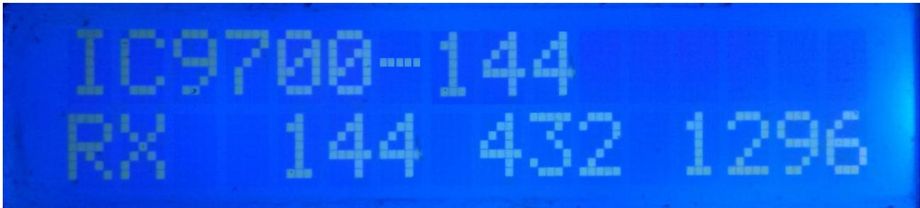
Wenn i-SEQ über den C-IV-Port mit dem Transceiver kommuniziert, werden in der oberen Zeile des Bildschirms das Modell des Transceivers und das gelesene Band angezeigt. In der unteren Zeile des Bildschirms wird angezeigt, dass der Transceiver empfangen wird und die Ausgänge für die Vorverstärker mit 144.432 und 1296 MHz aktiviert sind. Falls nicht das richtige Band empfangen wird, wird IC9700-OUT auf dem Bildschirm angezeigt.
