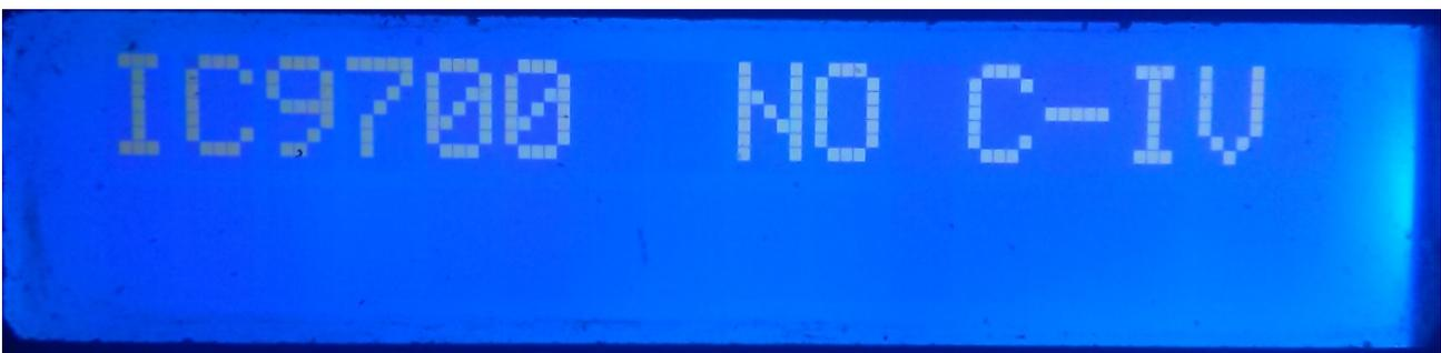
Die Standardeinstellung für i-SEQ ist 19200 Baud, hexadezimale Adresse A2 und 20 ms Verzögerung für die Aktivierung von Übertragungsverstärkern. Sobald die i-SEQ-Konfiguration geändert wurde, wird sie wie konfiguriert gestartet.
