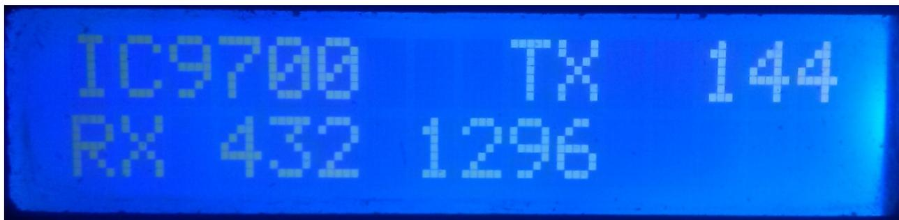
En la línea superior de la pantalla nos mostrará el modelo del transceptor. A continuación de esta, nos indicará que el transceptor está en transmisión en la banda que indica y por lo tanto ha activado la salida del rele del amplificador correspondiente a dicha banda. En la línea inferior de la pantalla, nos indicará que las salidas para los preamplificadores están activas para las bandas indicadas.
