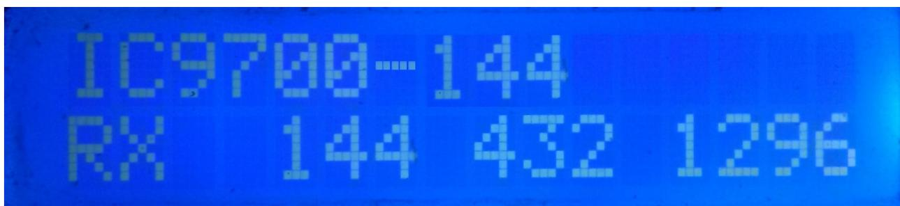
Se o i-SEQ tiver comunicação com o transceptor pela porta C-IV, ele nos mostrará na linha superior da tela no modelo do transceptor e a banda lida, bem como se estiver no modo Automático ou por PTT externo. Na linha inferior da tela, ele indicará que o transceptor está em recepção e as saídas para os pré-amplificadores de 144.432 e 1296 MHz estão ativadas. Caso não receba a banda correta, IC9700-OUT será exibido no tela.
