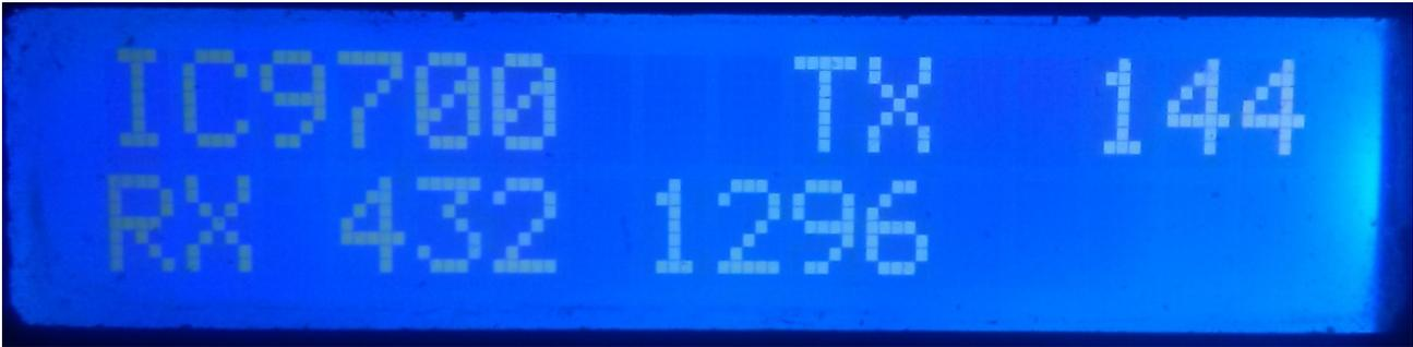
Na linha superior da tela, ele nos mostrará o modelo do transceptor. Em seguida, ele indicará que o transceptor está transmitindo na banda que indica e, portanto, ativou a saída de relé do amplificador correspondente a essa banda. Na linha inferior da tela, ele indicará que as saídas dos pré-amplificadores estão ativas para as bandas indicadas.
