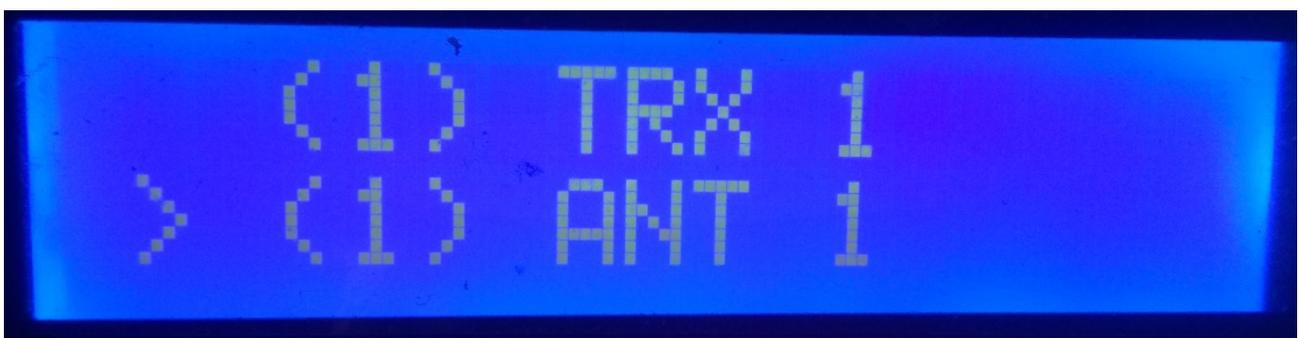
La configuración por defecto i-Switch , permite el control manual de un solo transceptor y la selección de hasta seis antenas y/o filtros . Una vez cambiada la configuración i-Switch arrancara según lo configurado.
