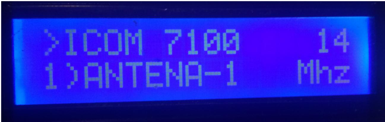
i-Switch è davvero un programma creato per Arduino Uno o Arduino Pro Mini 16Mhz, insieme a uno schermo LCD 16X2 con I2C e un codificatore che ti consente di fare tutte le funzioni necessarie senza usare alcun pulsante aggiuntivo per selezionare fino a sei antenne e / o filtri passa-banda e fino a due ricetrasmittitori manualmente o automaticamente. In altre parole, un comando per il controllo di interruttori autocostruiti o commerciali. Non è necessario un PC per configurarlo.
