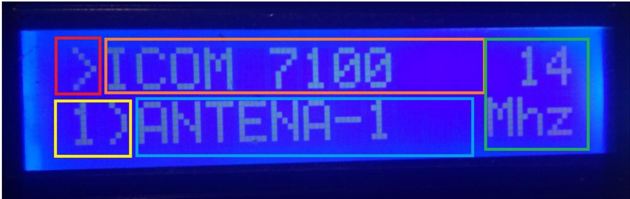
Nella riga superiore dello schermo, il simbolo ">" appare nella casella in rosso, indicando che possiamo cambiare il numero del ricetrasmittitore attivo con l'encoder, se nella configurazione abbiamo selezionato l'uso di 2 ricetrasmittitori.
