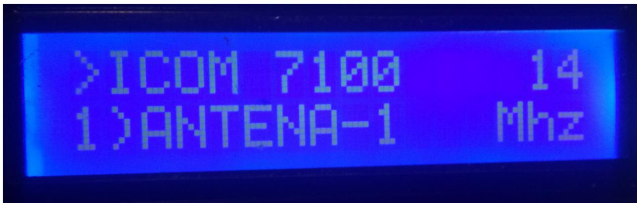
O i-Switch é realmente um programa criado para o Arduino Uno ou Arduino Pro Mini 16Mhz, junto com uma tela LCD 16X2 com I2C e um codificador que permite executar todas as funções necessárias sem usar nenhum botão adicional para selecionar até seis antenas e / ou filtros passa-banda e até dois transceptores, manual ou automaticamente. Em outras palavras, um comando para o controle de switches auto-construídos ou comerciais. Você não precisa de um PC para configurá-lo.
