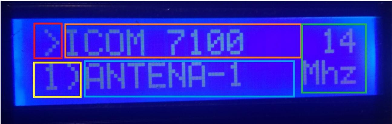
Na linha superior da tela, o símbolo ">" aparece na caixa em vermelho, indicando que podemos alterar o número do transceptor ativo com o codificador, se na configuração tivermos selecionado o uso de 2 transceptores.
